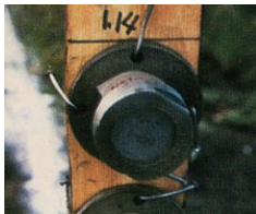
図3 鉛板の爆圧計
